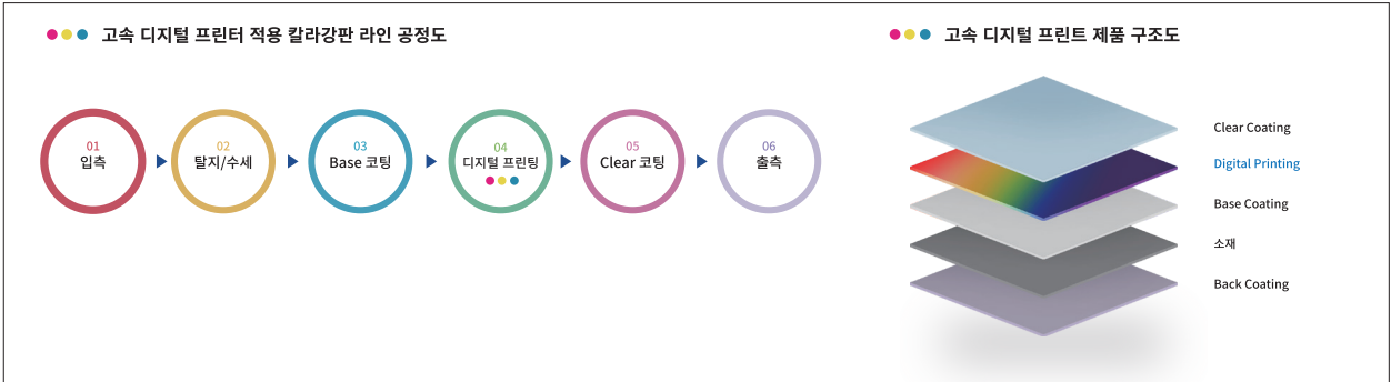
그림 3 | 아주스틸의 디지털 프린팅 컬러강판 공정도 및 제품 구조도
